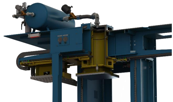
Verfahrbare Schiess- und Begasungseinheit Schiessereinheit mit Schussieb
